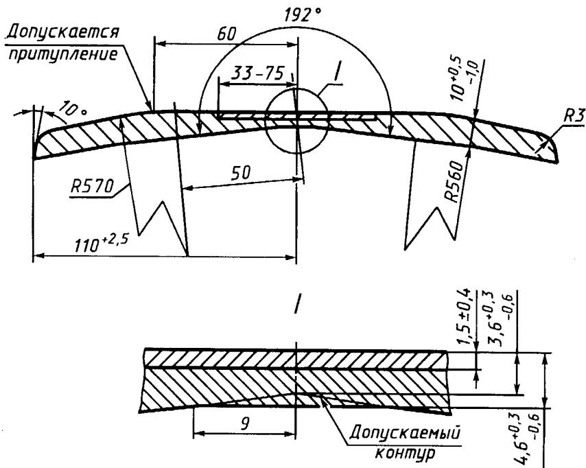
1.4. Допускается увеличение или уменьшение радиуса рабочей поверхности полосы по сравнению с указанным на чертеже.
